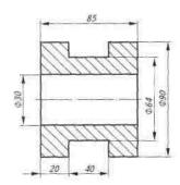
Графическая работа № 6 Прочитайте чертеж сборочной единицы «подшипник скольжения» по алгоритму, выполните технический рисунок детали.
